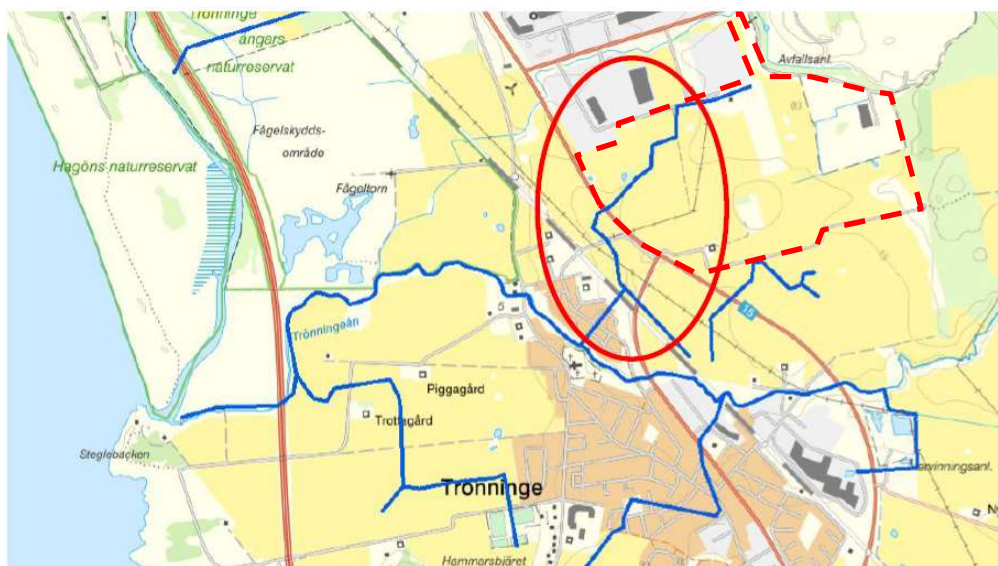
Figur 9. Dikningsföretag i planområdets närområde. Aktuell del av dikningsföretaget, Trönninge och Kistinge år 1954, är markerad med röd ring (Sweco, 2020). Röd streckad linje visar den ungefärliga planområdesgränsen.
