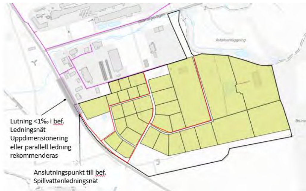
Figur 14. Röda linjer representerar föreslaget spillvattennät. Lila linjer visar befintligt ledningsnät. I figuren ses kvartersmark i transparent gul.
