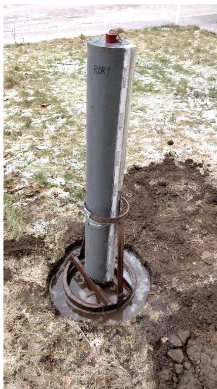
Figur 5. T.v. skiss över infiltrometer. T.h. exempel på installerad infiltrometer.
