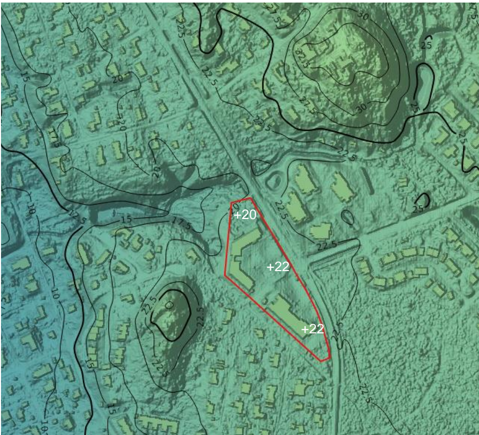
Figur 3 Höjddelning inom utredningsområdet. Utredningsområdet ungefärliga gräns markerad med rött polygon. Källa: SCALGO LIVE.
