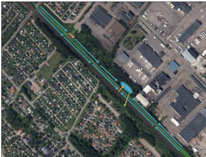
Figur 3 Föreslaget dagvattensystem i den östra delen, med svackdiken och en damm (se utredning D)
