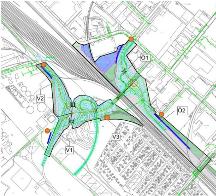
Figur 4. Föreslaget dagvattensystem i den västra delen, med föreslagna svackdiken i blått. De orangea punkterna markerar ungefärliga föreslagna anslutningspunkter (se utredning F)
