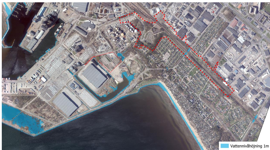
Figur 7: Vattennivåhöjning på 1 meter, Södra infartens utredningsområde är markerat med streckad röd linje.
