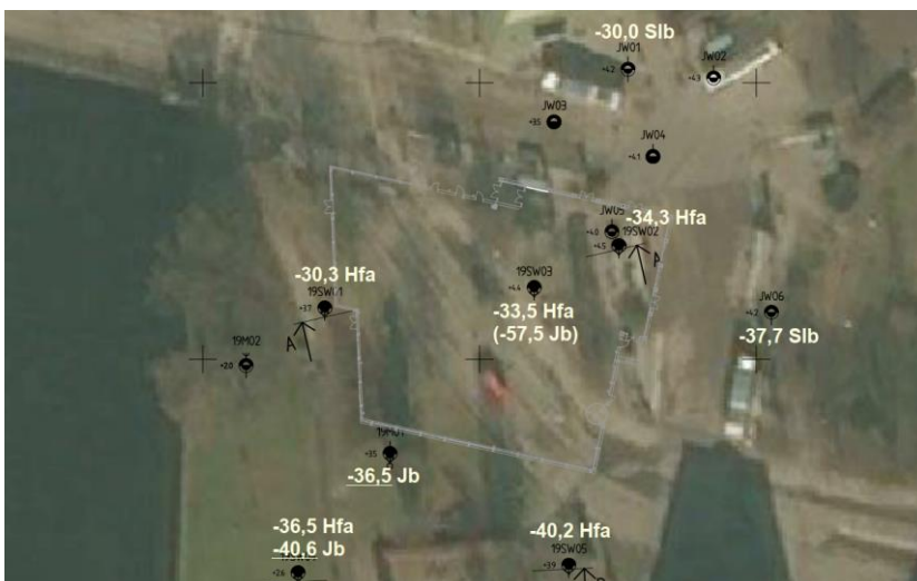
Figur 7. Stoppnivåer för hejarsonderingar (Hfa) och tung slagsondering (Slb). Jb betecknar jordbergborring där understruken nivå betecknar bergnivåbestämning. Inom parantes betecknar nivå där sondering avslutats utan att berg säkert kunnat konstateras.
