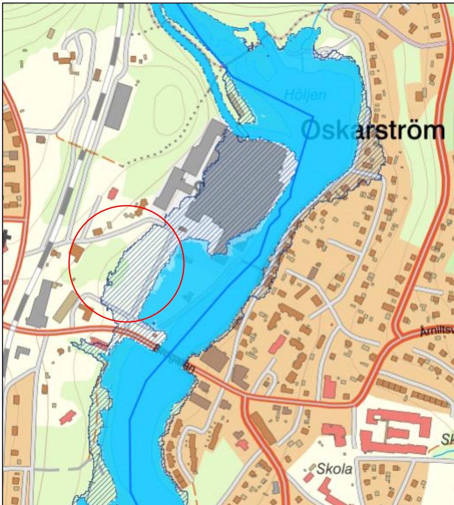
Figur 15. Översvämningsnivån vid högsta beräknade flöde. Linjerad mörkblå utbredning visar högsta översvämningsnivån. Röd cirkel visar placering av planområdet.
