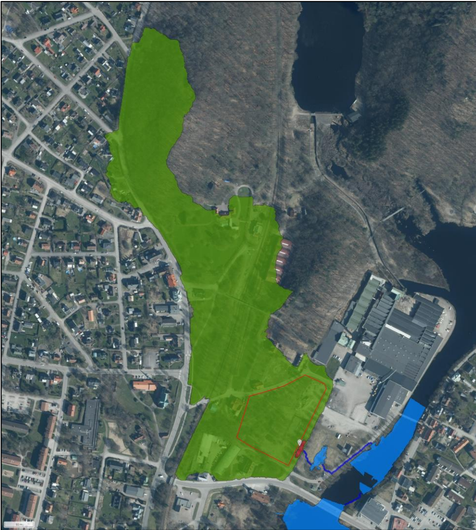
Figur 4. Arealen på avrinningsområdet är 13 ha. Grönt = Avrinningsområdet. Rött = Lågpunkt. Blått = Möjlig utströmningsväg. Planområdets läge är markerat med rött (SCALGO Live, 2023).
