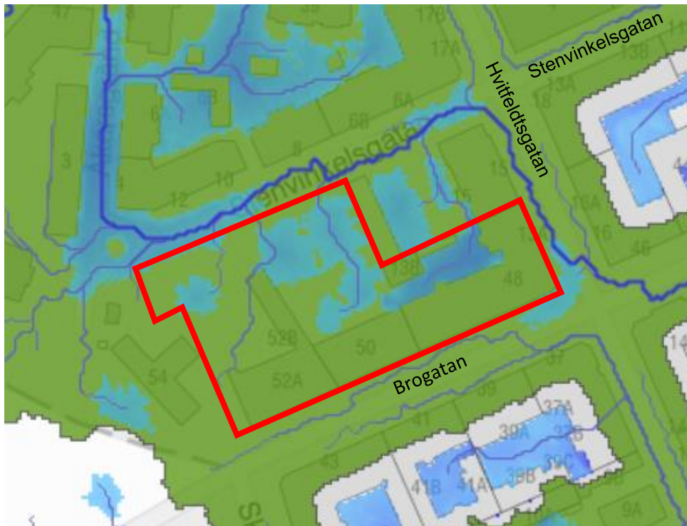
Figur 6. Skyfallsstråk och lågpunkter inom och i angränsning till planområdet. Figuren visar endast skyfallsstråk som har en tillrinnande yta på minst 200 m 2 . Planområdets ungefärliga gräns markerat i rött. Källa: Scalgo Live.
