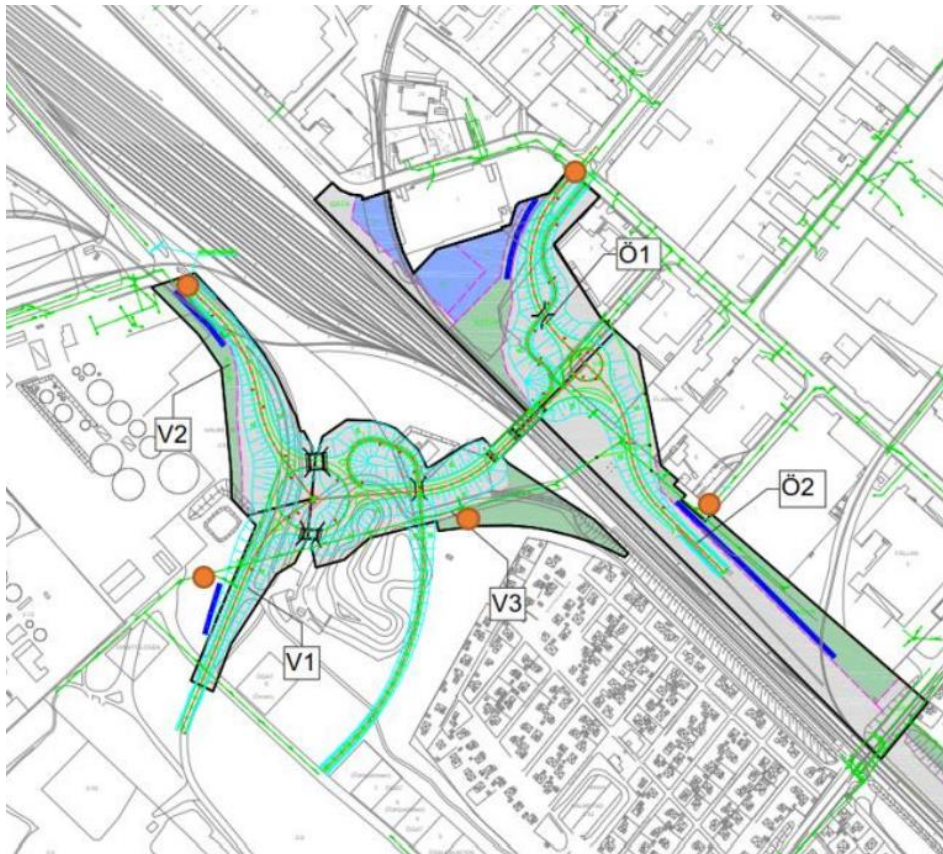
Figur 5 Skiss av ungefärligt ytbehov för att uppnå erforderlig fördröjning (blå heldragna linjer). Orange punkter visar ungefärliga föreslagna anslutningspunkter (Sweco, 2020).
