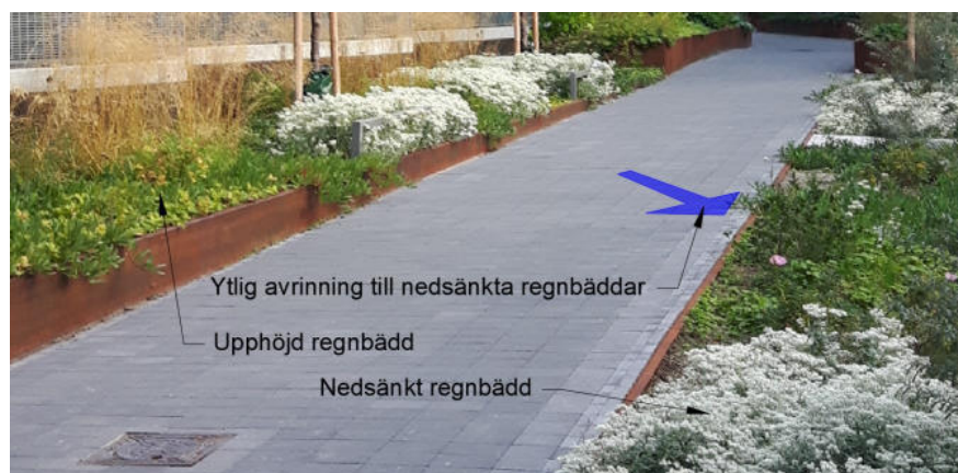
Illustration över en kombination av upphöjda respektive nedsänkta regnbäddar med ytlig avrinning från hårdgjord mark till nedsänkta grönytor
